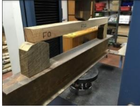
Figura 3: Montaje del ensayo de flexión
