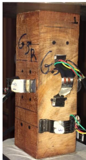
Figura 1: esquema de carga de CP de compresión.
