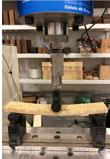
Figura 4: Realización del ensayo MOE y MOR
