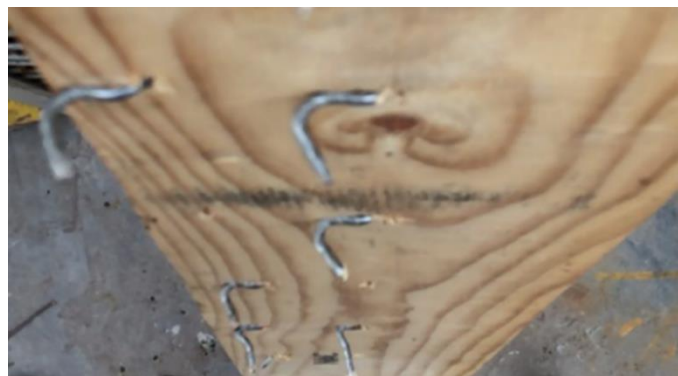
Figura 7: Comportamiento de las fijaciones a doble curvatura en ensayo cíclico
