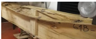
Figura 17: Separación de la guadua del patín
