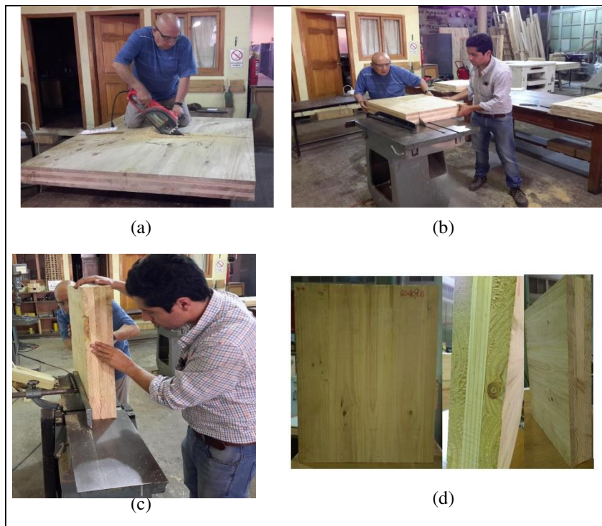
Figura 1: Secuencia del proceso de preparación de probetas. (a) corte de panel de CLT con motosierra, (b) corte de panel de CLT con sierra de mesa, (c) cepillado de cara lateral en canteadora, (d) probeta para ensayo. (Salas y Aravena 2017, Romero y Rossi 2016).
