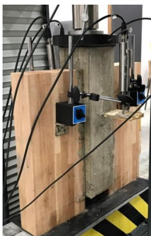
Figura 21b. Se consideró como desplazamiento relativo al promedio de las cuatro mediciones.
