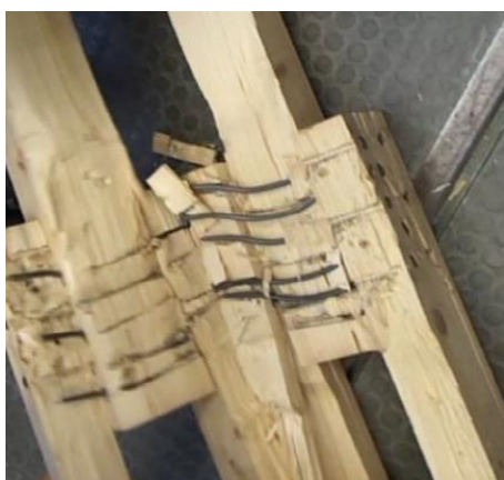
Figura 1: Uniones tipo clavija: falla dúctil con clavos (Viaje de Estudios MCM_UBB, septiembre 2009, Universidad de Biberach, Alemania) y falla frágil con pasadores (Blass & Schadle, 2011)
