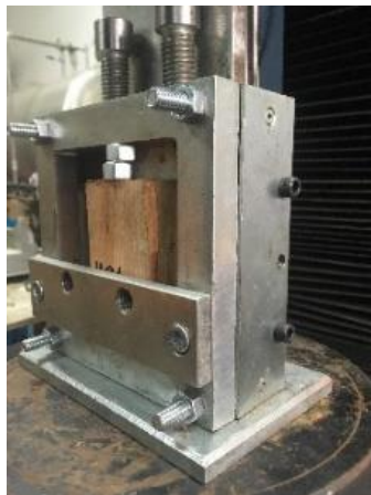
Figura 4: Montaje para el ensayo de Corte paralelo a la fibra
