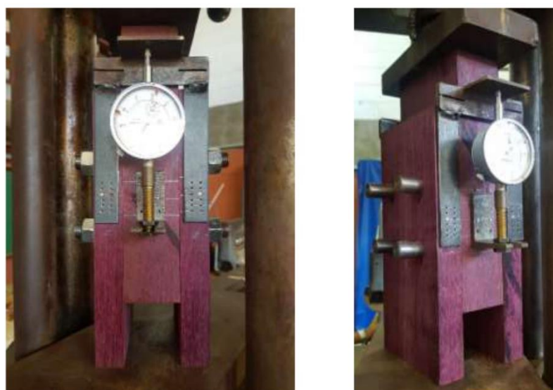
Figura 4: Ensaio de protótipos da ligação
