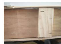
Figura 16: Desplazamiento relativo piezas de madera reutilizada
