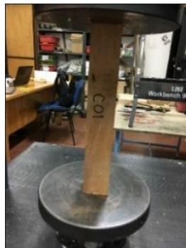
Figura 3: Montaje de ensayo de compresión paralela a la fibra.
