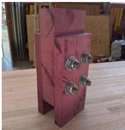
Figura 2: Exemplo de protótipo da ligação.
