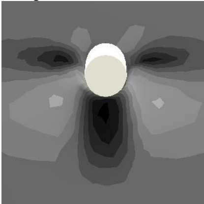
Figura 5: Caso 1. Componentes de la tensión en los tres ejes principales y tensión de corte en el plano XY.
