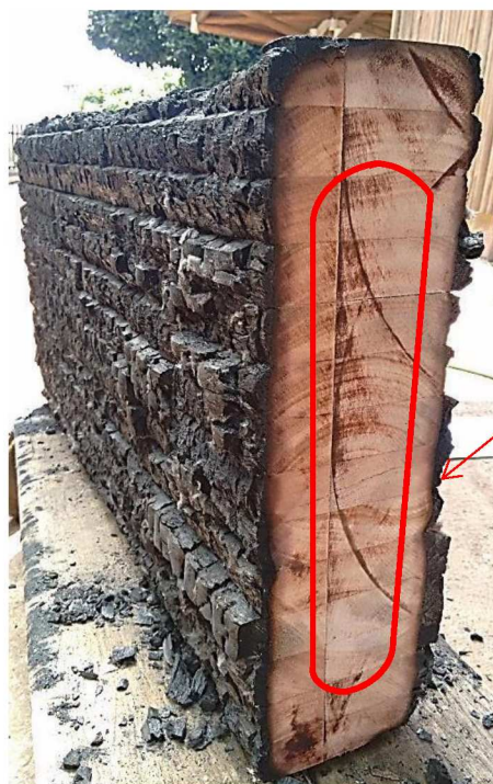
Figura 2: línea de degradación de resina epoxi(mediana)
