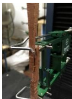
Figura 6: Montaje del ensayo de tracción paralela a las fibras
