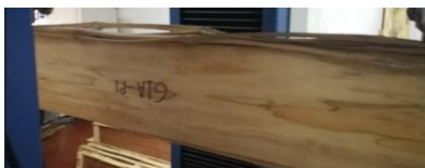
Figura 15: Deformación fibras del patín superior
