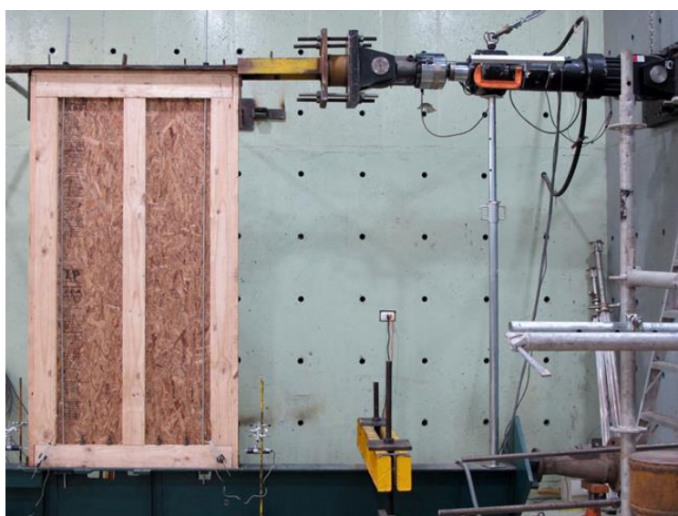
Figura 3: Configuración de ensayo de carga lateral cíclica.
