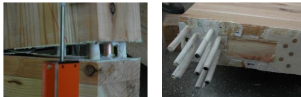
Figura 7: extracción de clavijas de madera
