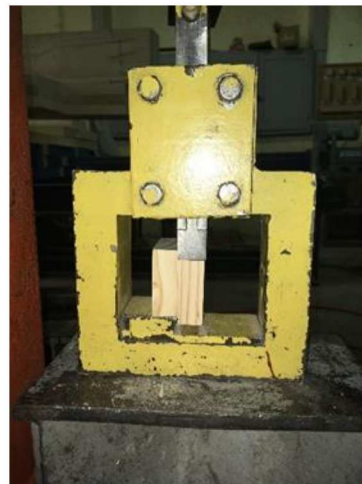
Figura 3: Montaje para ensayo de cizalle a través del adhesivo. (Acuña y Cofré 2018).
