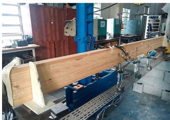
Figura 4: Viga preparada para o ensaio.
