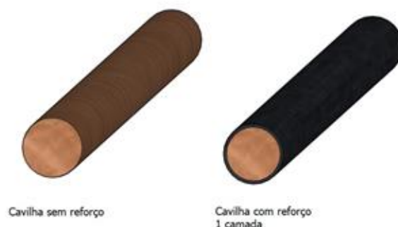
Figura 18: Perspectiva do corpos-de-prova do ensaio de flexão nas cavilhas.
