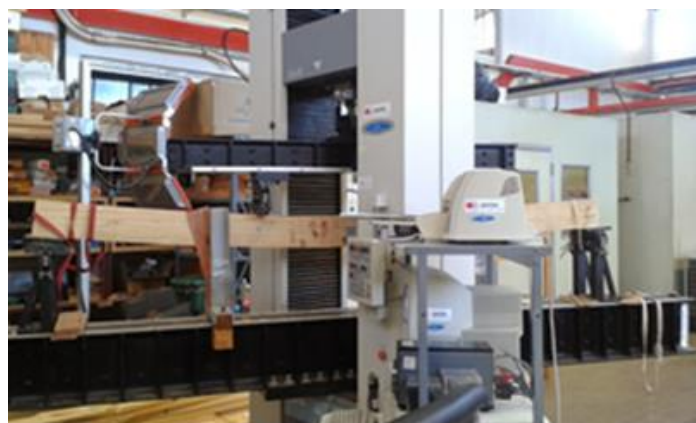
Figura 2: Dispositivo experimental para determinar el módulo de elasticidad en máquina universal
