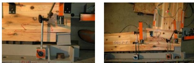
Figura 13: Falla de la articulación
