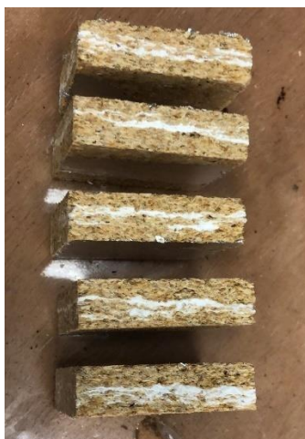
Figura 3: Muestras para ensayo de adhesión interna
