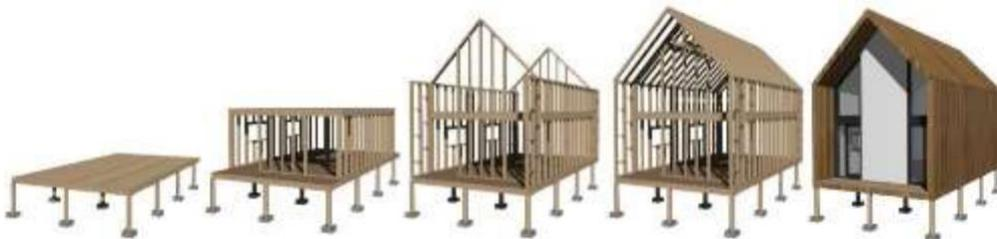
*Figura 1: Modelo de referencia utilizado en la aplicación del ejercicio dirigido en diferentes pasos de ensamblaje.*
