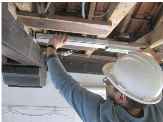
Figura 13: Perfuração com Resistógrafo
