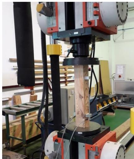
Figura 3: Izquierda ensayo de viga a tamaño real. Derecha, Compresión de probeta mediana.
