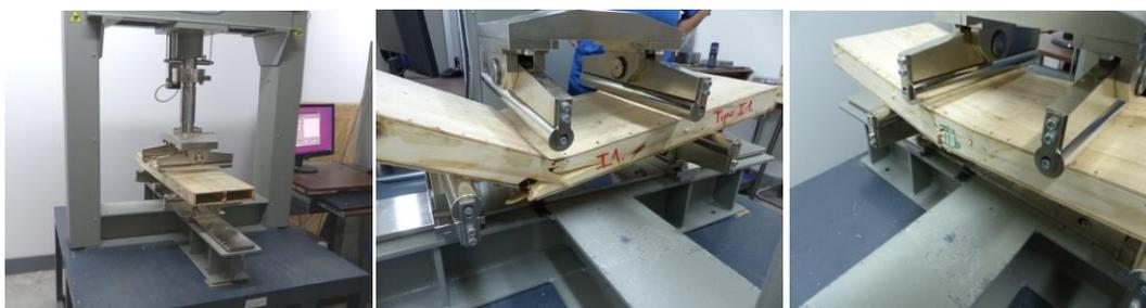
Figura 2: Prensa universal Controls y formas de rotura de las losetas.
