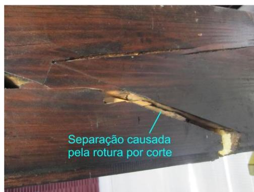
*Figura 6: a) Vista geral b) Rotura por corte c) Abertura da junta d) Plastificação do ligador*
