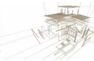
manera: **Paso 1. Estructura:** comprende cementos (bloques de cementos y pilotes); Estructura de planta baja (vigas, barras y OSB); Paredes de la planta baja (guías y montantes), estructura de la planta superior (vigas, barras y OSB); Paredes del piso superior (guías y montantes) y estructura del techo (martes, vigas, vigas cuando sea necesario); **Paso 2. Cierres;** y finalmente, **Paso 3. Aperturas.**
