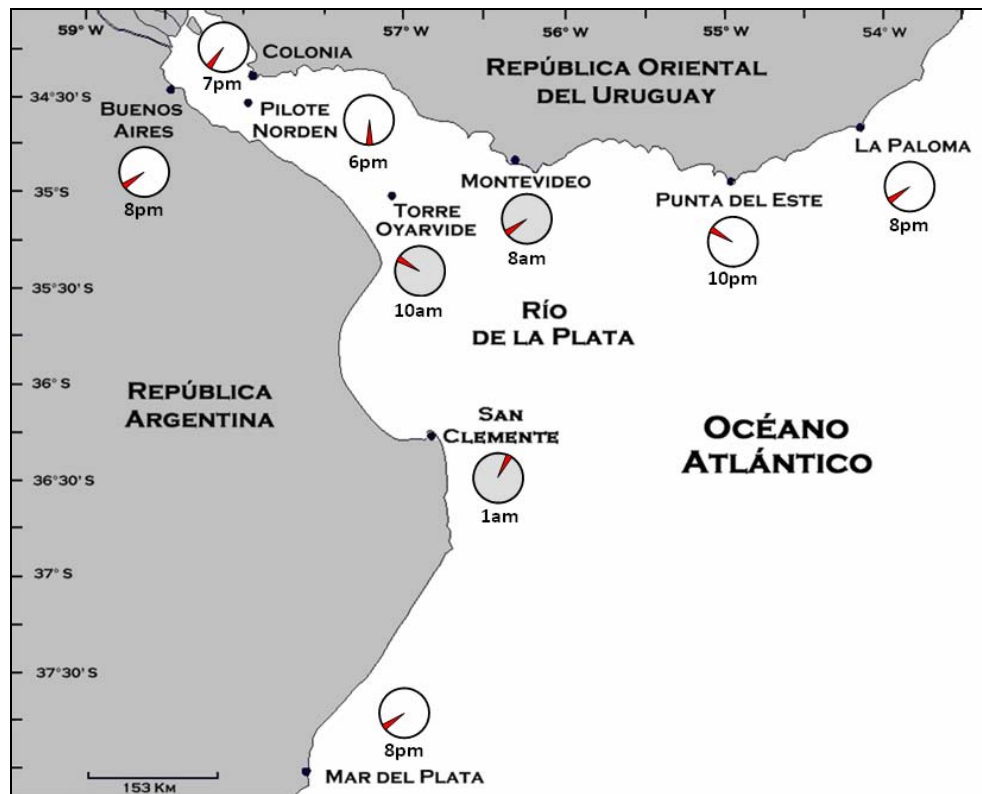
Figura 38: Fase de la componente M2 en horas respecto a GMT.
