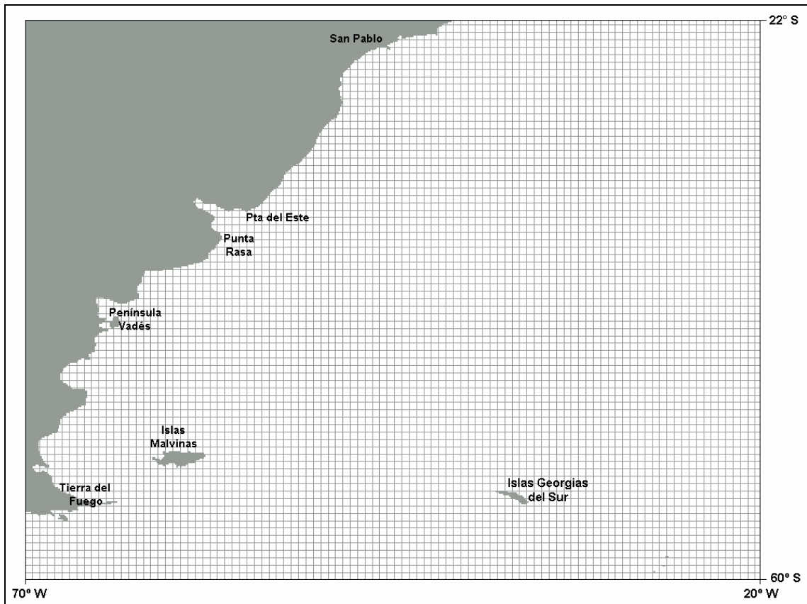
Figura 26: Malla de cálculo del modelo regional del modelo pre-operacional PDT.
