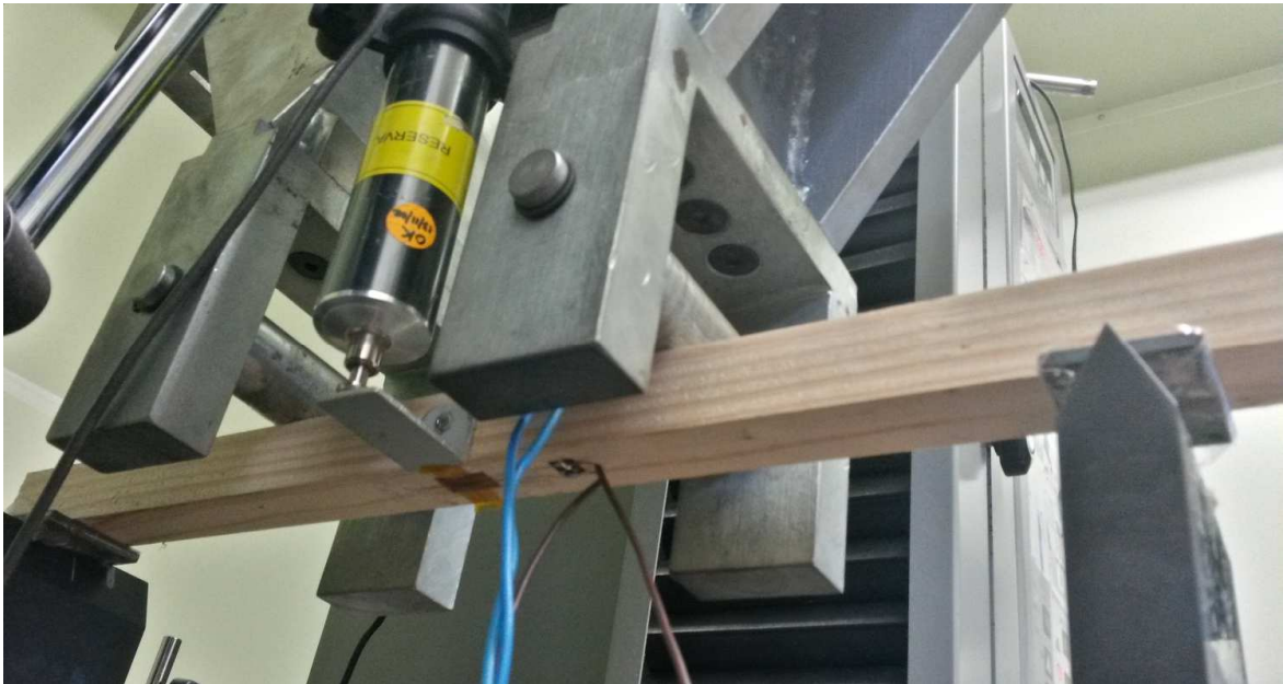
Figura 4. Detalle del dispositivo de ensayo, donde se aprecia el corte de la probeta, la galga extensométrica en la cara inferior y el extensómetro para medir flecha global
