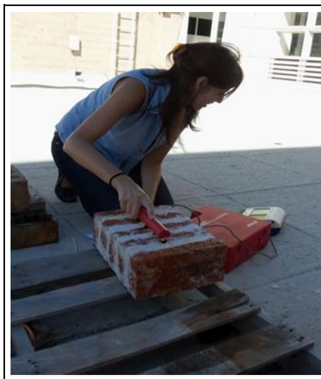
Figura 4.11. Medidas de resistividad eléctrica sobre murete.
