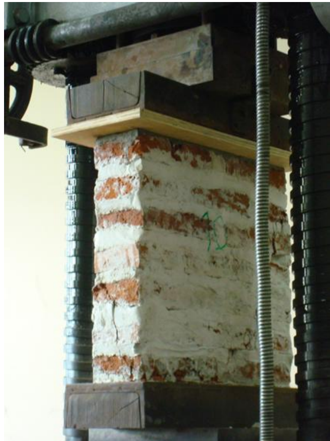
Figura 3.29. Ensayos de compresión sobre murete.
