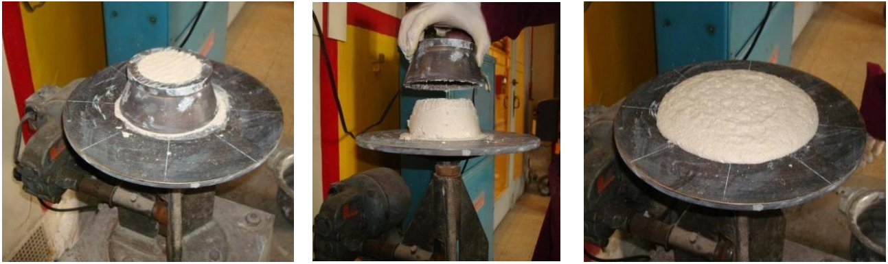
Figura 3.4. Determinación del escurrimiento y consistencia de morteros sobre mesa de sacudidas.
