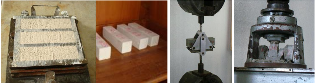
Figura 3.27. Ensayo de resistencia a compresión y tracción por flexión de morteros
