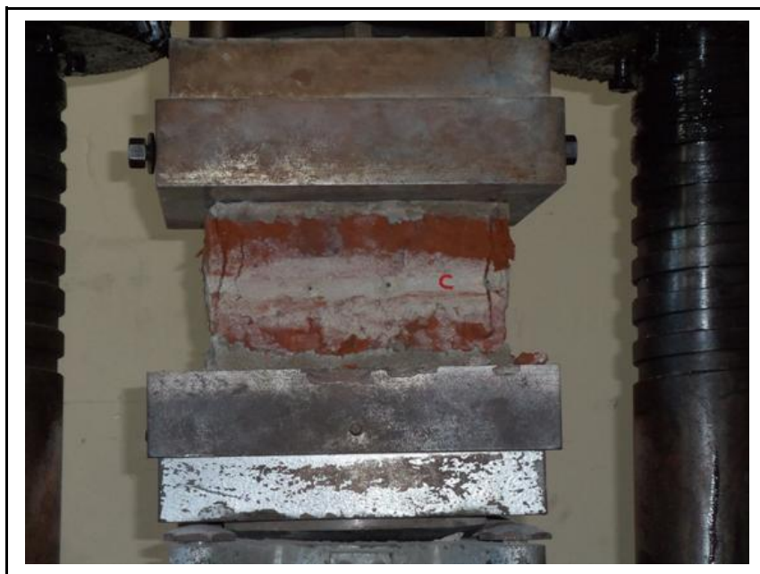
Figura 4.32. Ensayo mecánico destructivo sobre probeta doble.
