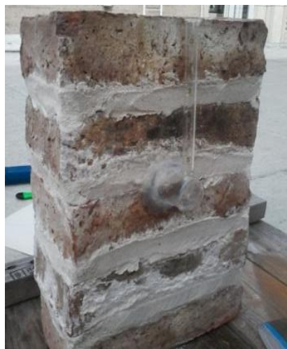
Figura 4.10. Ensayo de permeabilidad sobre murete.
