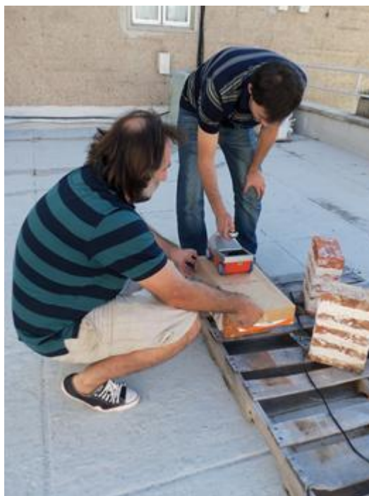
Figura 3.22. Aplicación del geo-radar a una probeta de ensayo.
