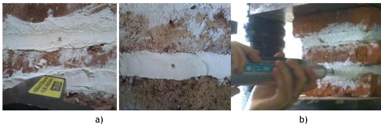
Figura 4.37. a) Ensayo de resistencia a la penetración; b) Ensayo de dureza superficial sobre probetas denominadas tripletas.
