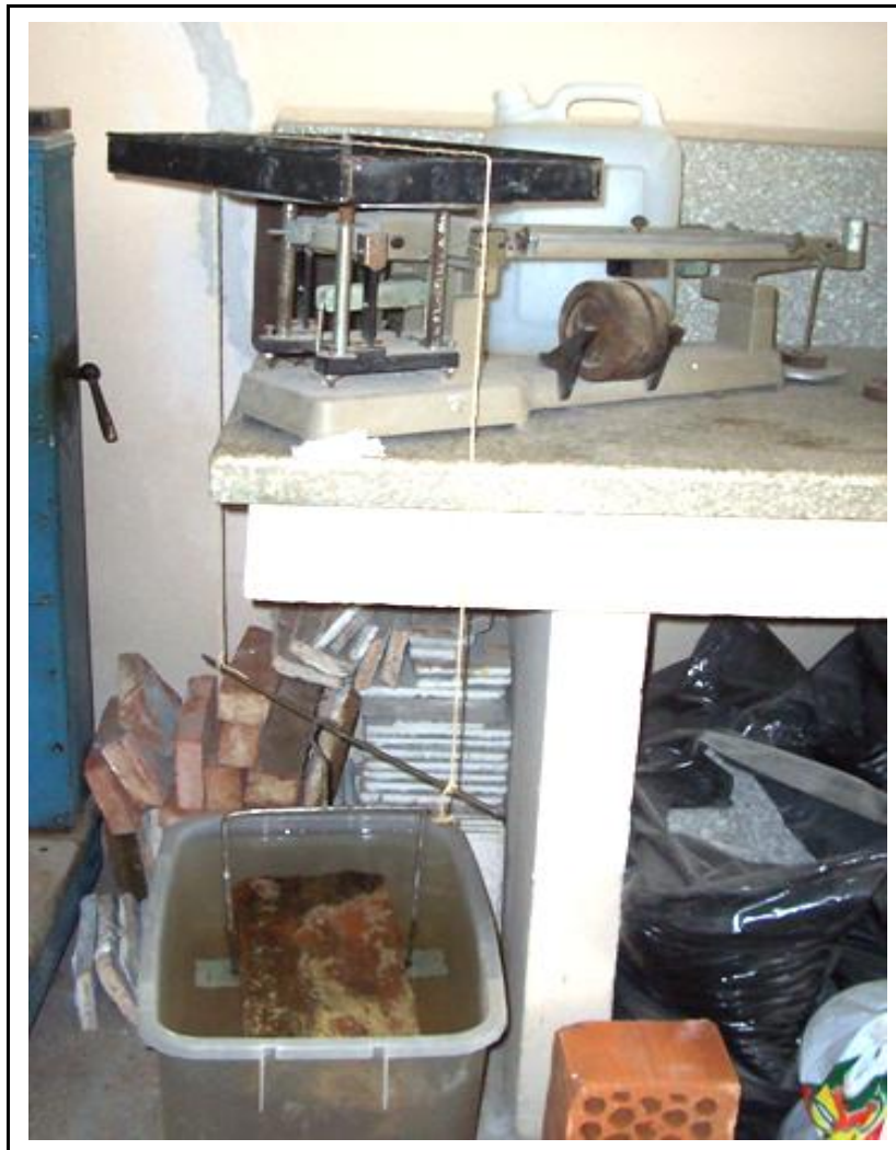
Figura 4.7. Medidas de densidad de ladrillos.
