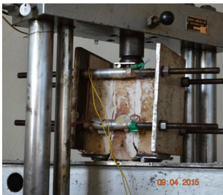
Figura 3.31. Ensayo de resistencia inicial al cizallamiento o cortante con fuerza previa de compresión perpendicular a la junta de asiento.
