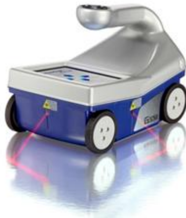
Figura 3.7. Radar penetrante de tierra para hormigón (Marca GSSI, modelo StructureScan Mini).
