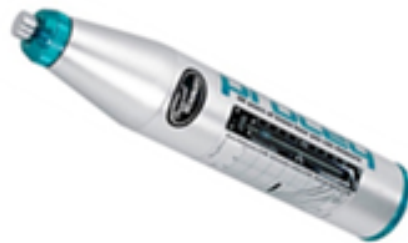
Figura 3.14. Martillo Schmidt, marca Proceq de baja energía, tipo L.
