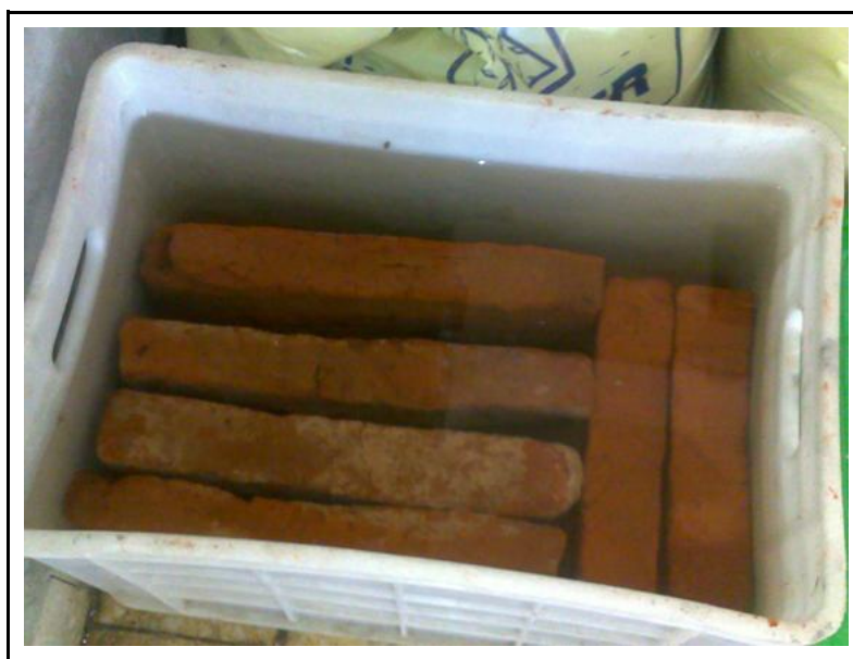
Figura 4.9. Ensayo de absorción de ladrillos.
