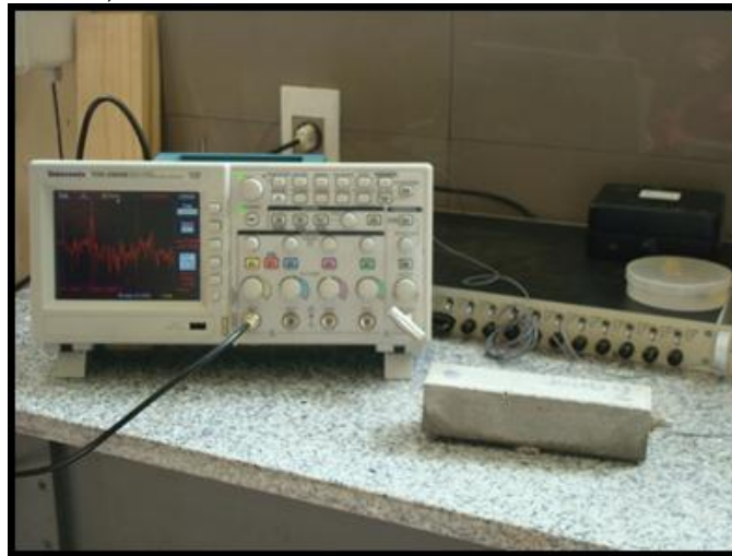
Figura 3.33. Osciloscopio utilizado en ensayo de resonancia.
