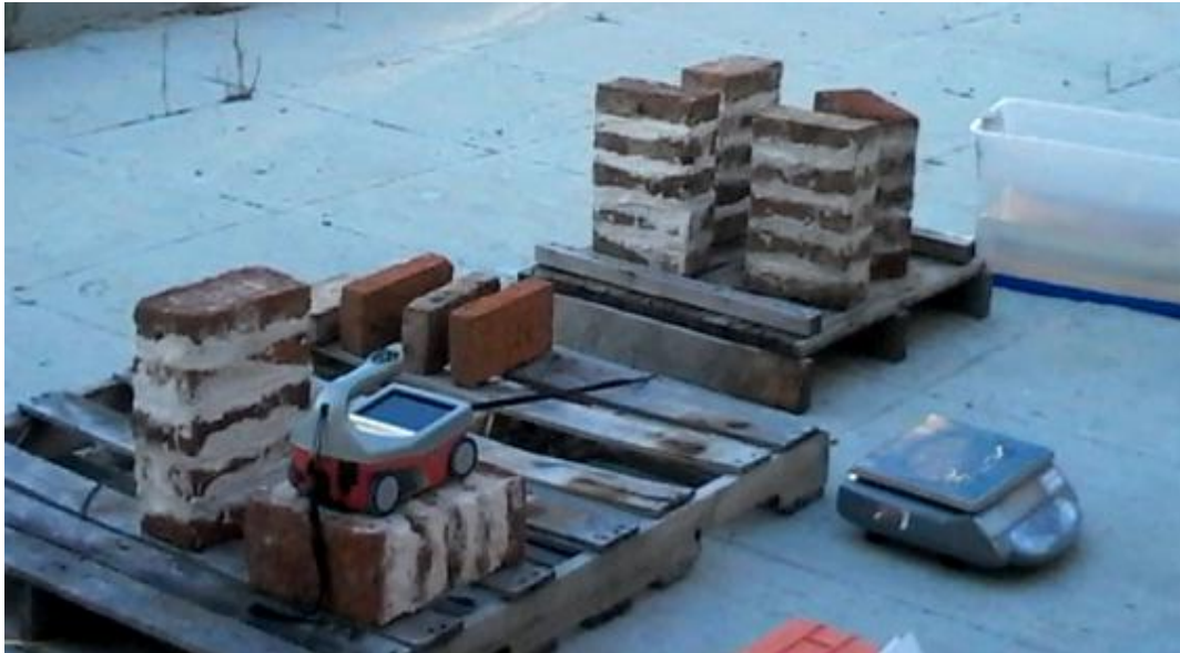
Figura 3.19. Probetas en condiciones de exposición para aplicación de los ensayos de permeabilidad, resistividad eléctrica, determinación de la constante dieléctrica mediante el empleo del geo-radar.
