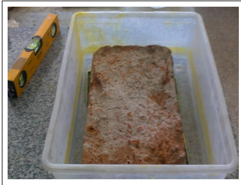
Figura 4.8. Ensayo de tasa inicial de absorción de ladrillos.
