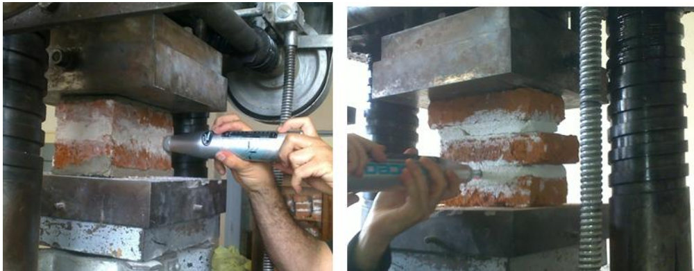
Figura 3.36: Medidas de dureza superficial con el Esclerómetro sobre diversas probetas.
