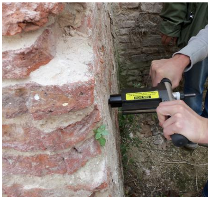
Figura 3.37. Aplicación del Windsor Pin.
