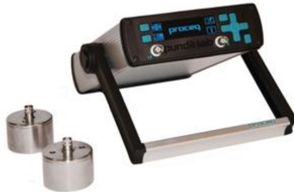
Figura 3.11: Equipo para el ensayo de ultrasonido.
