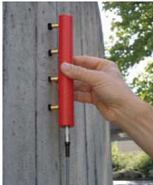
Figura 3.21. Sonda de cuatro polos o sistema Wenner.
