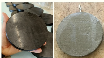
Figura 1. A la izquierda un cupón de polietileno de alta densidad y a la derecha un cupón de cemento.
